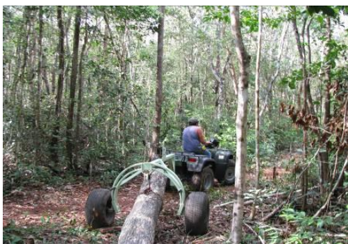
Figuras 8 y 9. Fotos de arrastre con cuatrimotos en el ejido Trapich
