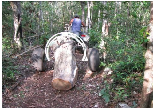
Figuras 8 y 9. Fotos de arrastre con cuatrimotos en el ejido Trapich
