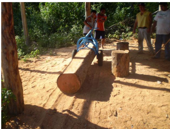
Figura 14. Arrastre de madera con sully
