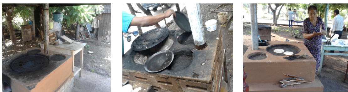
Figura 9.17 Detalle de las estufas ahorradoras de leña “patsari”
