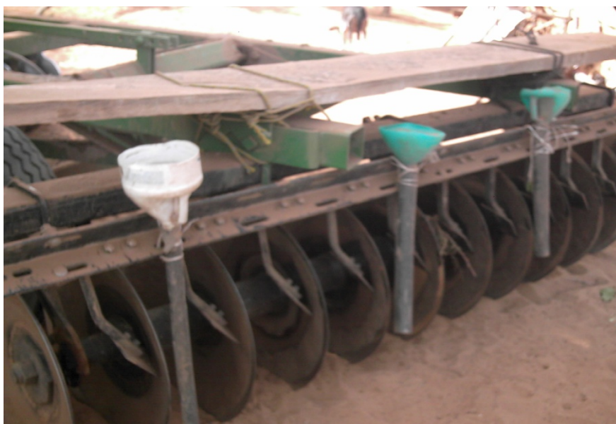
Figura 4.3.9 Acondicionamiento de rastra para sembrar ajonjolí en suelos arenosos de la costa de Jalisco.
