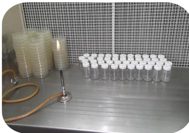
**Figura 10.** Preparación de muestras para determinar unidades formadoras de colonia  $\text{mL}^{-1}$  de solución nutritiva.
