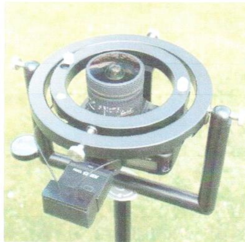
Figura 11. Sostén, sistema de nivelación, lente hemisférica y cámara.
