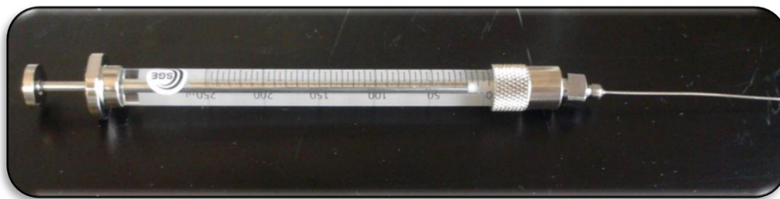
Figura 12. Jeringa empleada para inyectar las diferentes muestras en el CG.
