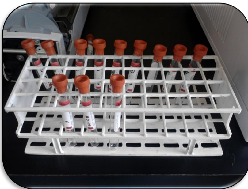
Figura 14. Muestras tomadas de los biorreactores para su posterior lectura en el CG.
