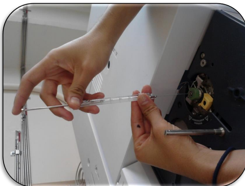
Figura 16. Inyección de las distintas muestras a analizar en el inyector del CG.
