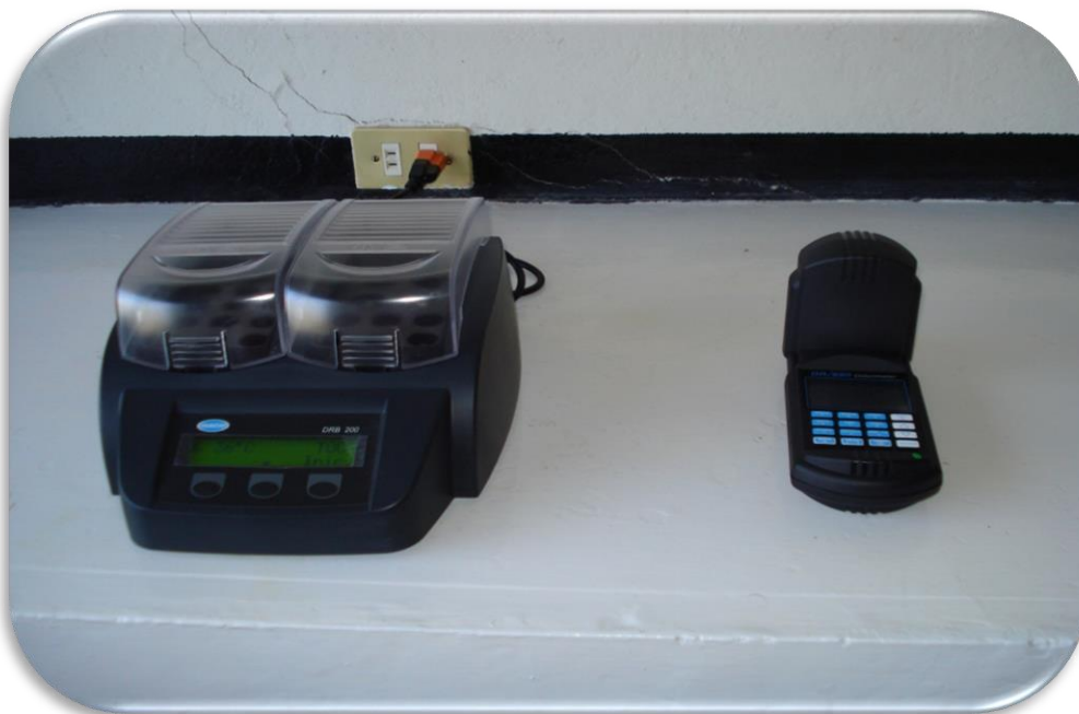
Figura 18. Termoreactor y espectocolorímetro utilizados para el análisis de muestras.
