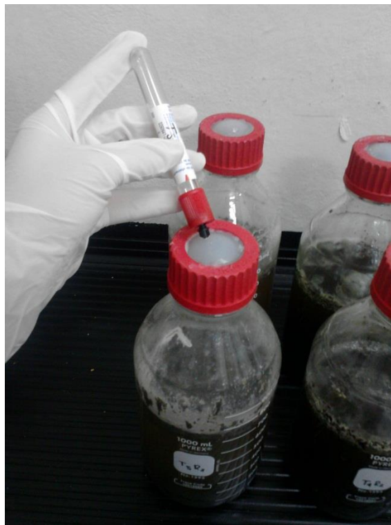
Figura 4. Toma de muestra de gas metano para su posterior cuantificación.
