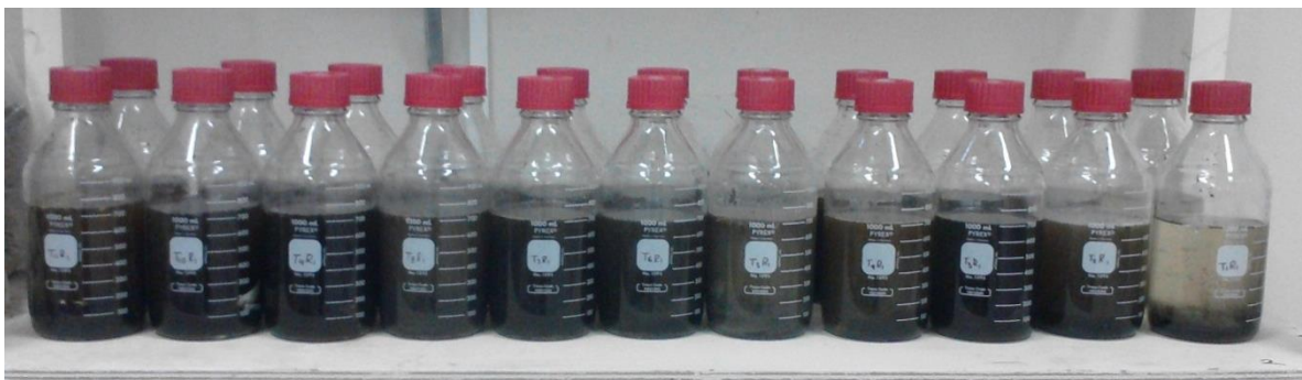
Figura 3. Preparación y montaje de los reactores Batch en el laboratorio.
