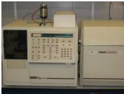
**Figura 22.** Cromatógrafo de gases.
