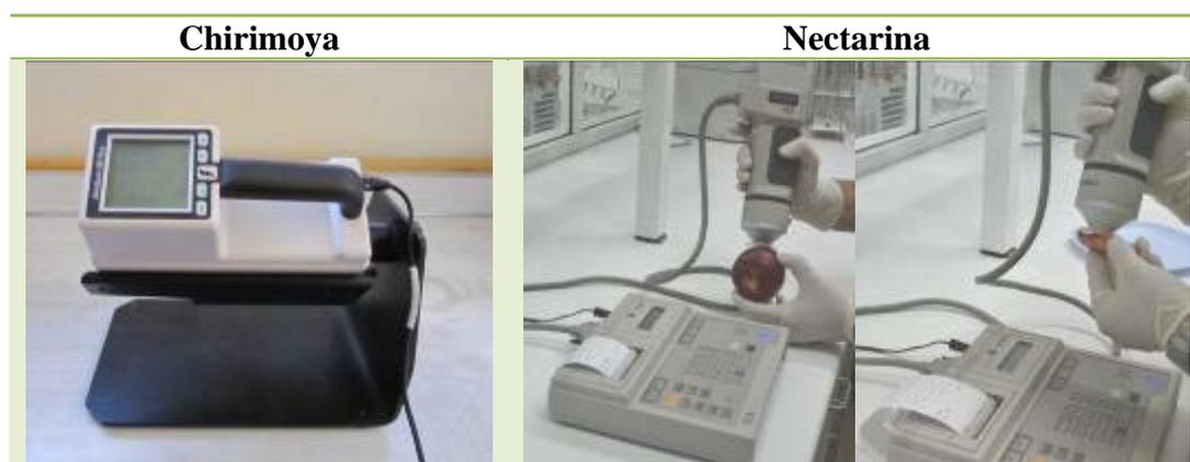
**Figura 29.** Colorímetros para la medición del color.
