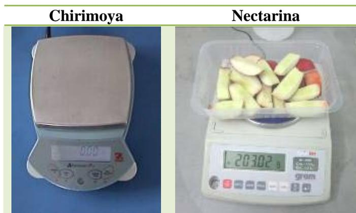
**Figura 30.** Balanzas semianalíticas ocupadas en la determinación de la pérdida de peso.
