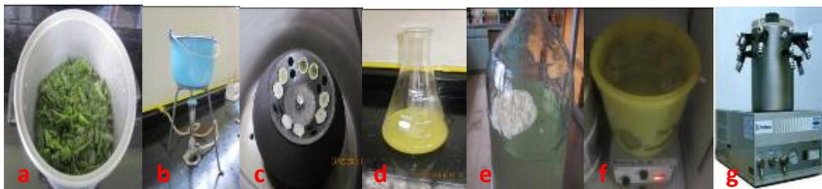
**Figura 13.** Proceso de extracción del mucilago de nopal. a) troceado del nopal, b) cocción, c) centrifugado, d) sobrenadante de centrifugado, e) separación de mucílago con etanol, d) dializado y g) liofilizador utilizado para la deshidratación de mucílago.
