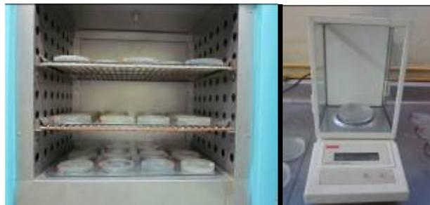
**Figura 21.** Monitoreo de la cinética de pérdida de peso para la determinación de permeabilidad a vapor de agua
