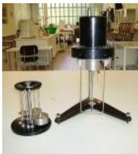
**Figura 16.** Viscosímetro de Brookfield
