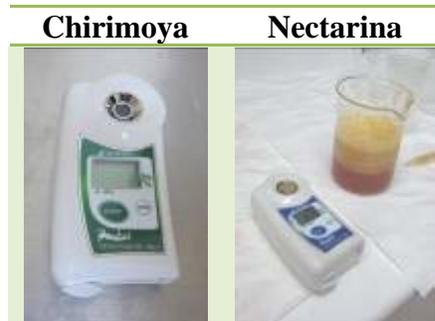
**Figura 32.** Refractómetros usados en la determinación de sólidos solubles.
