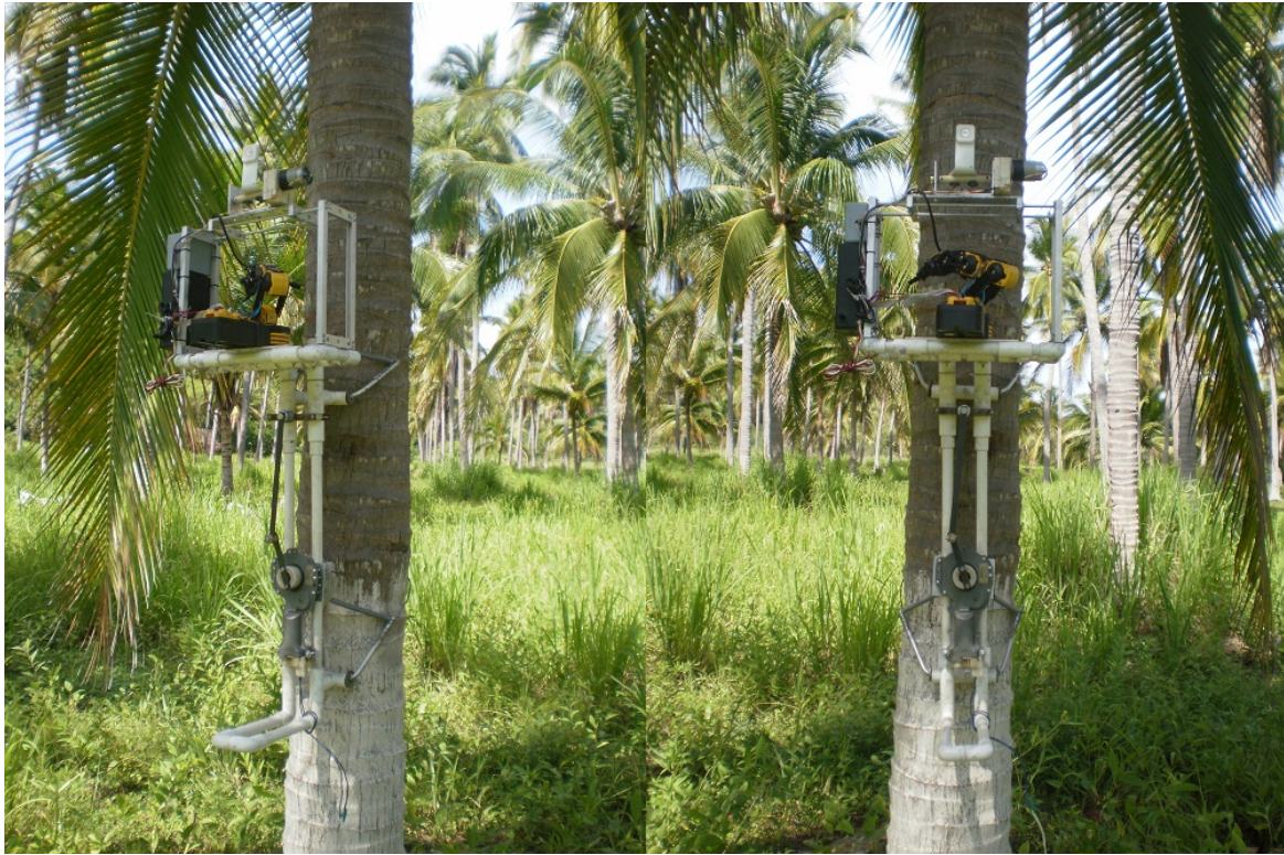
Figura 3.4: Sistema mecánico del robot construido con PVC.
