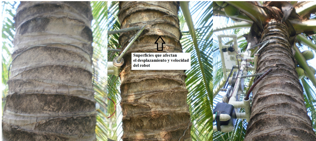
Figura 3.8: Superficies que afectan el desplazamiento y velocidad del robot durante el ascenso.
