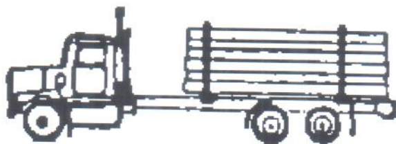
Figura 14. Camión maderero pequeño para longitudes de trozas comerciales
