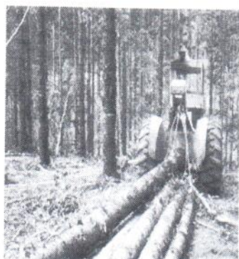
Figura 8. Arrastre terrestre con por medio de eskaider
