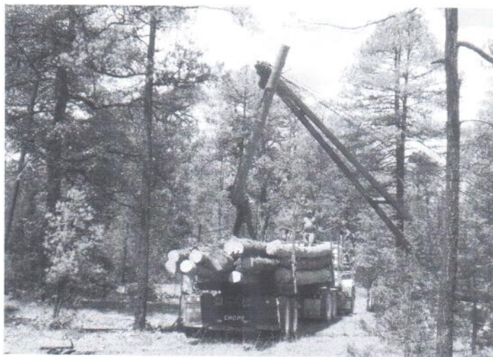
Figura. 27. Carga de camión con motogrúa (acomodo de troza)
