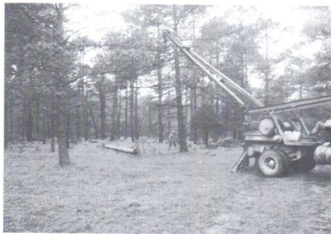
Figura 26. Arrastre con cable por medio de motogrúa
