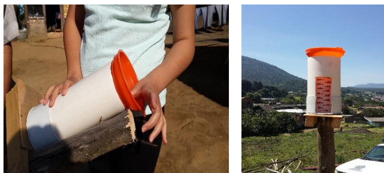
Figura 1. Pluviómetro artesanal. Tomada: Diana Fuerte
