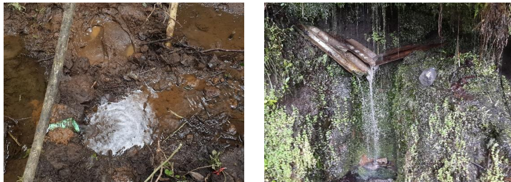
Figura 3. Determinación del caudal de agua del manantial Curipo y Condiro.
