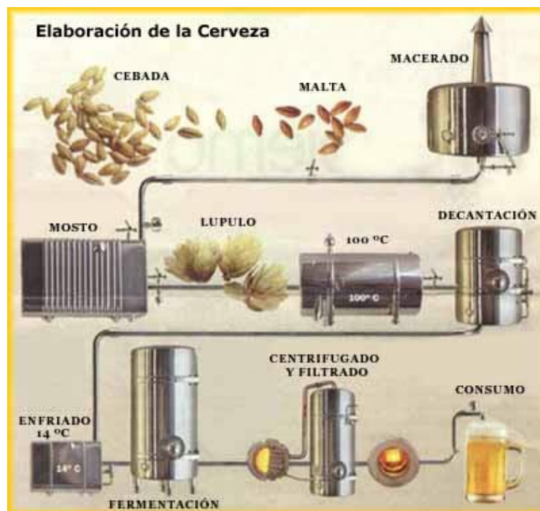
Fig. 3.1 Proceso de producción de cerveza (Fig. tomada de Club planeta, 2012).
