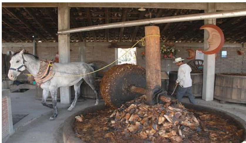
Fabrica tradicional de elaboración de mezcal artesanal, molienda de la penca de maguey.
