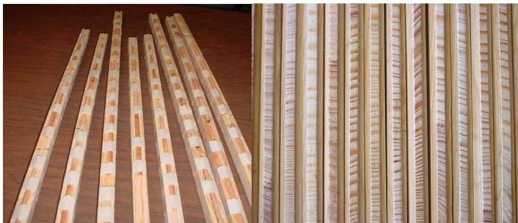
Figura 10. a) Preparación y montado de núcleos de crecimiento, etapa básica para el inicio de análisis dendrocronológico de la muestra y b) muestras pulidas y preparadas para el conteo de crecimiento en microscopio.
