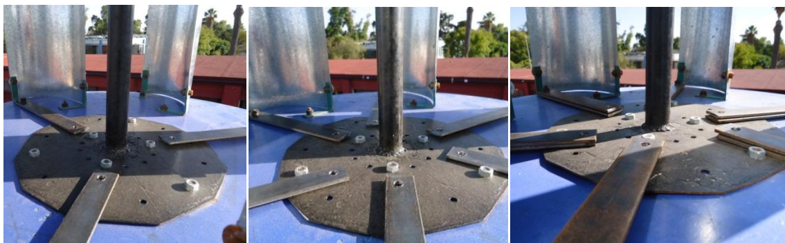
Fig. 2.19 Colocación de las soleras en las pruebas 6, 7 y 8
