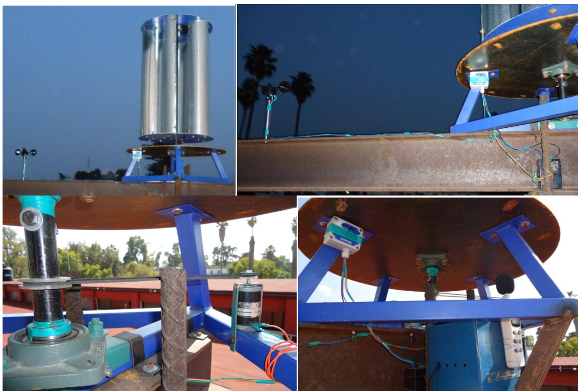
Fig. 2.14 Localización de los sensores
