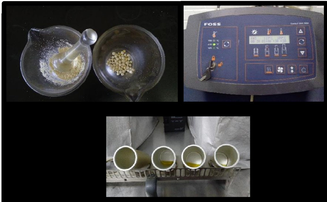
Figura 14. Extracción de aceite de Moringa oleifera en extracor Soxtec™ 2050 Auto System para determinar contenido de aceite (38-39%).
