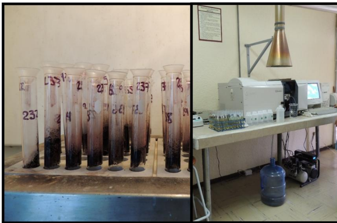
Figura 11. Digestión de muestras de tejido vegetal y lectura en espectrofotómetro de absorción atómica
