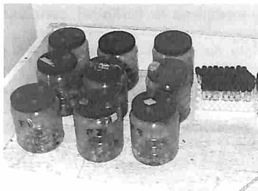
Figura 5. Unidades experimentales para la toma de muestra en la medición de respiración por el método estático.
