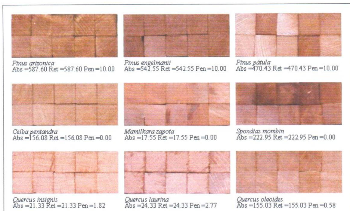
Figura 10. Imágenes de la penetración de la creosota a vacío-presión en las 9 especies. (Absorción, Ret = Retención, Pen = Penetración).
