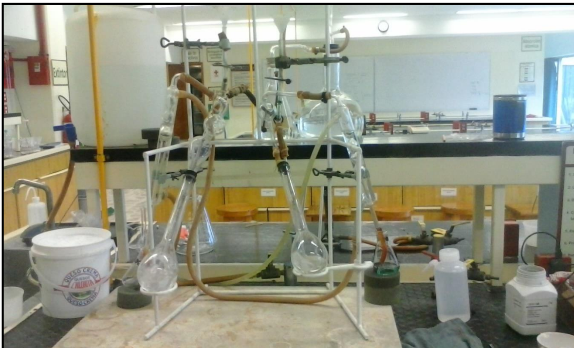
Figura 9. Determinación de nitrato y amonio por arrastre de vapor.
