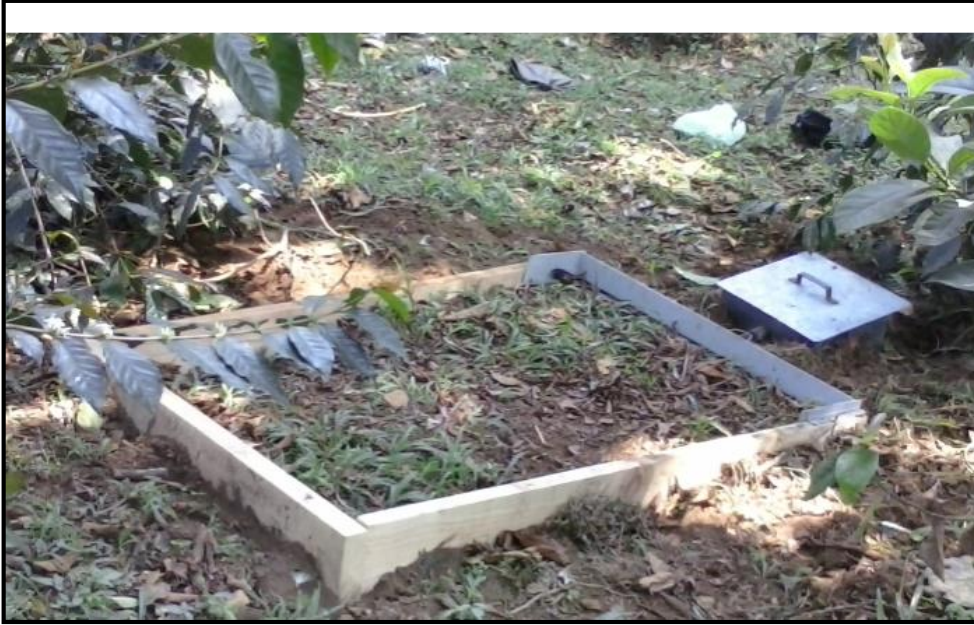
Figura 4. Parcelas de escurrimiento usadas en el sitio experimental.
