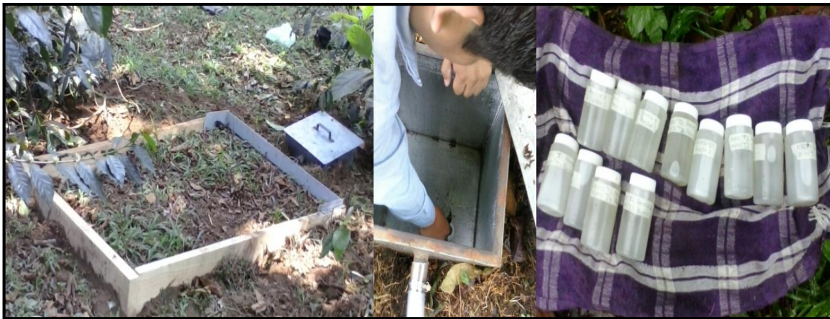
Figura 6. Parcelas Escurrimiento, toma y almacenamiento de muestras para determinar pérdida de suelo.
