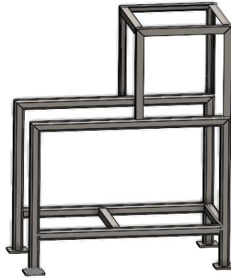
Figura 10. Chasis de PTR diseñado en SolidWorks
