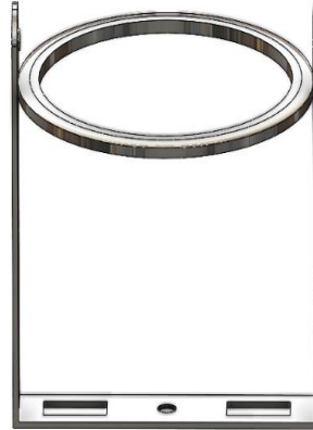
Figura 16. Soporte de la tolva, diseñado den SolidWorks
