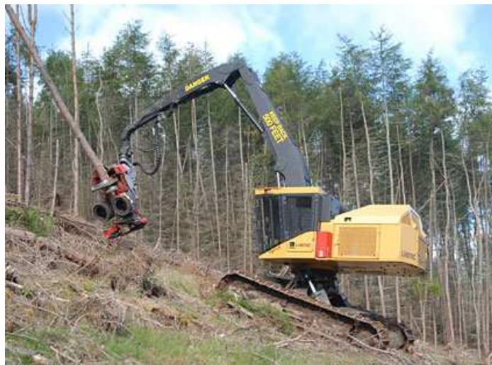
Figura 6.4. Cosechadora forestal Tigercat LH870C (Tigercat, 2008)
