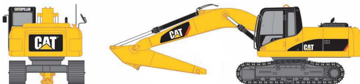
Figura 8.3. Excavadora Caterpillar 320D (Caterpillar, 2005).
