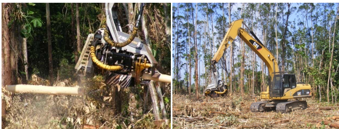
Figura 8.1. Cosechadora forestal, cabezal Kesla adaptado a la excavadora Caterpillar, Huimanguillo, Tabasco.
