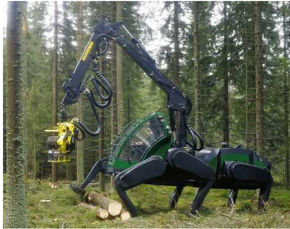
Figura 6.5. Cosechadora de patas articuladas, (Tolosana et al., 2004).
