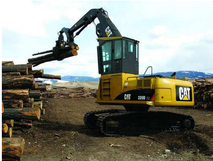
Figura 6.3. Excavadora forestal Caterpillar 320D FM (Caterpillar, 2009).
