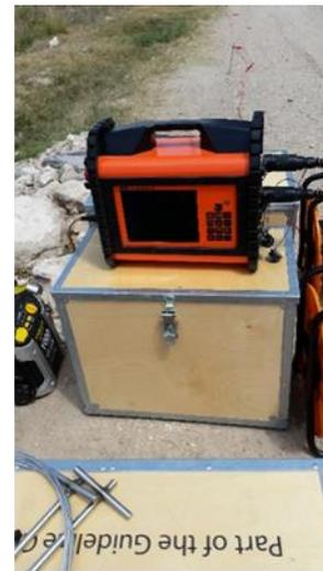
**Figura 14.** Equipos de prospección eléctrica resistiva, a) Georesistivimetro SAS 300B, b) Tomógrafo Terrameter LS 100.
