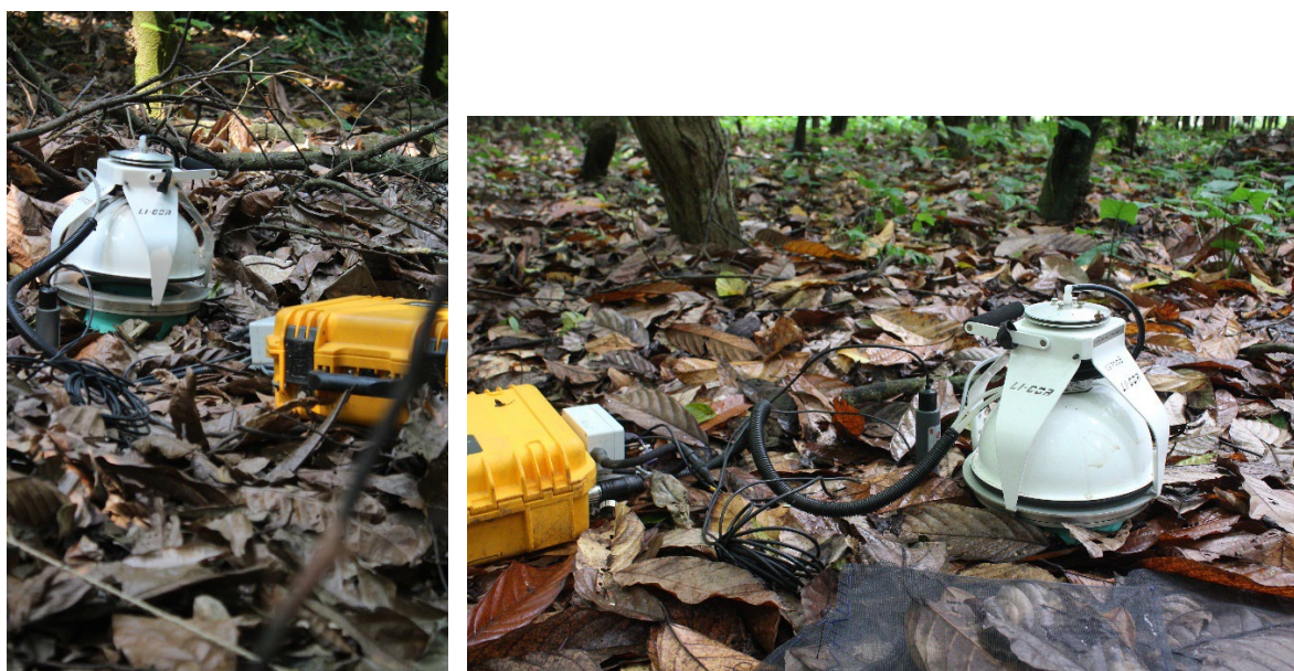
Fig. 6.2. Utilización de cámara dinámica cerrada (8100A LICOR) en campo.
