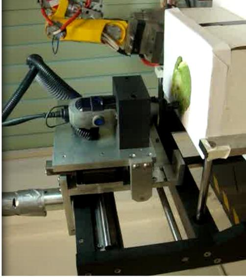
(b) Posicionamiento del cortador vertical sobre la hoja
