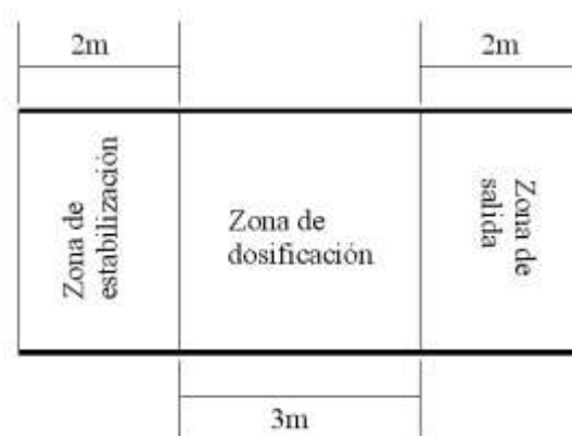
Figura 23. Esquema de la pista de pruebas de campo.
