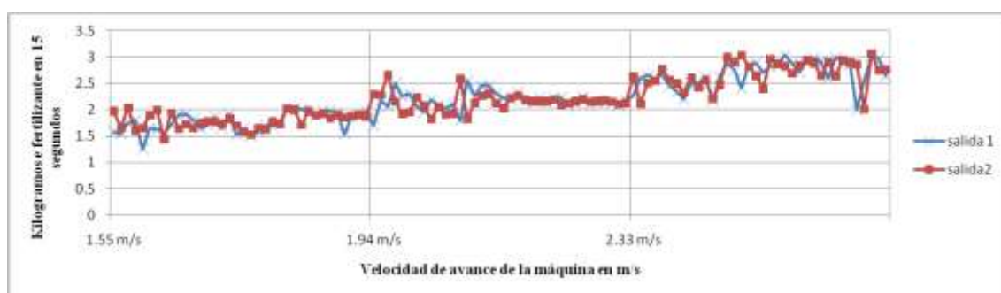
Figura 44. Comportamiento de la dosificación del fertilizante por salida.
