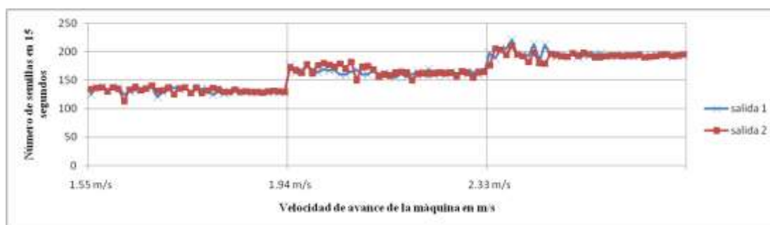
Figura 46. Comportamiento de la dosificación de semilla por salida.
