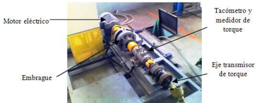
Figura 9. Partes del banco dinamométrico
