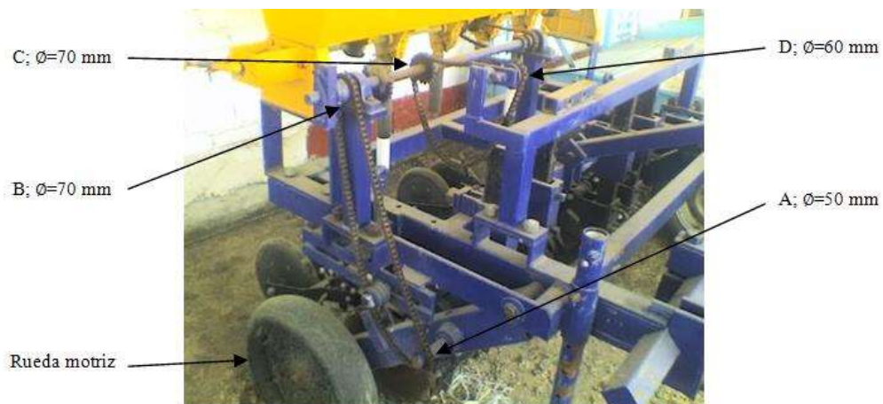
Figura 11. Transmisión de la sembradora versátil. Fuente. Limón, 2006.
