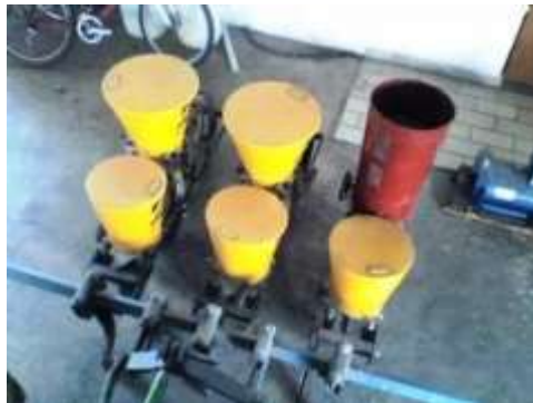
Figura 21. Vista del montaje de la sembradora a un chasis comercial
