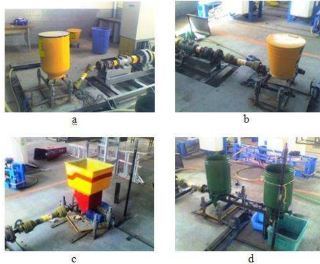
Figura 10. a) Dosificador comercial A, b) dosificador comercial B, c) dosificador comercial C, d) tolvas de la sembradora versátil.
