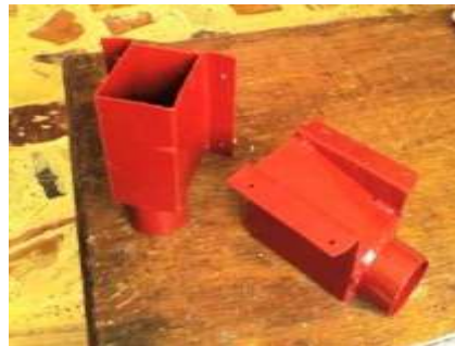
Figura 42. Conos de salida del material dosificado.
