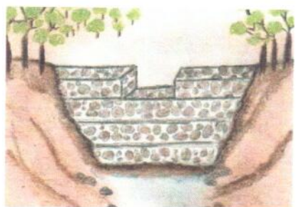
Figura 19. Presa de mampostería
