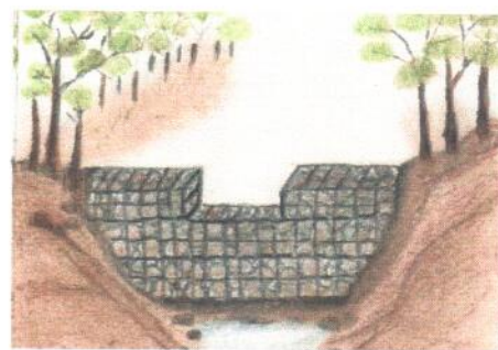
Figura 13. Presa de malla de alambre Fuente: CONAFOR, 2007; Modificado por Franco Islas
