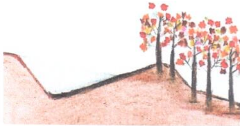
Figura 6. Terrazas de banco Fuente: TRAGSA, TRAGSATEC y Ministerio de medio Ambiente 1998; Modificado por Franco Islas
