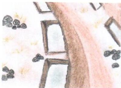
Figura 5. Terrazas de absorción Fuente: CONAFOR, 2007; TRAGSA, TRAGSATEC y Ministerio de Medio Ambiente, 1998; Modificado por Franco Islas
