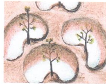
Figura 7. Terraza individual Fuente: CONAFOR 2007; Modificado por Franco Islas
