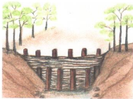
Figura 12. Presa de ramas. Fuente: CONAFOR, 2007; Modificado por Franco Islas
