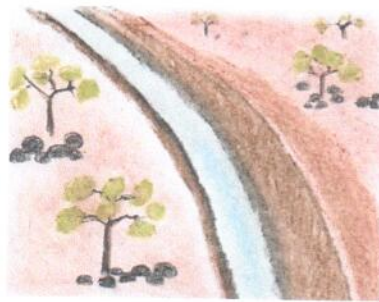
Figura 10. Zanja derivadora de escorrentía
