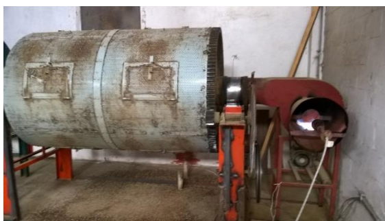
Fotografía no. 9. Secadora de café de tipo de rodillo con capacidad de 10 quintales de café con secado cada 24 horas.
