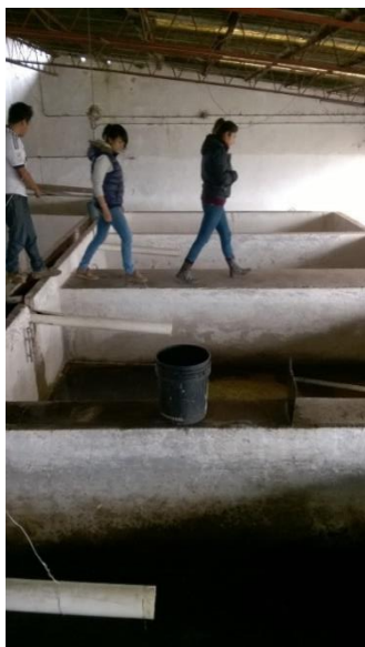
Fotografía no 11. Sifones o tanques para fermentación de café despulpado, capacidad de 20 quintales, material mampostería.
