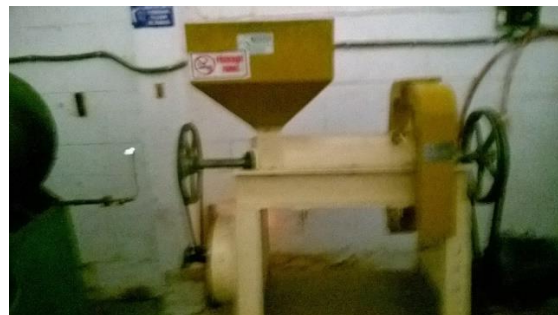
Fotografía no. 8 Morteadora de cuchillas para eliminar cascarilla de café pergamino, capacidad un quintal por hora, utilizar motor de 1hp.
