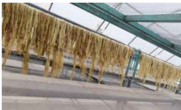
Figure 6.5. Fibras en secador solar
