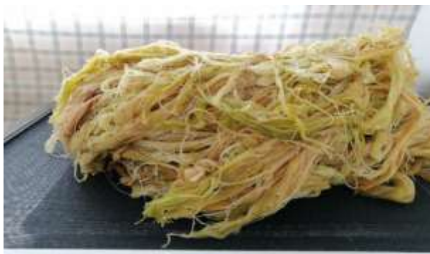
Figure 6.4. Fibras tratadas con NaOH
