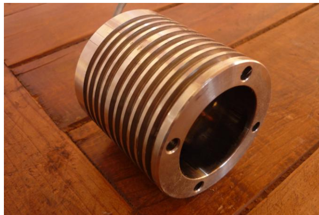
Figura 3. Camisa de condensación con aletas de enfriamiento
