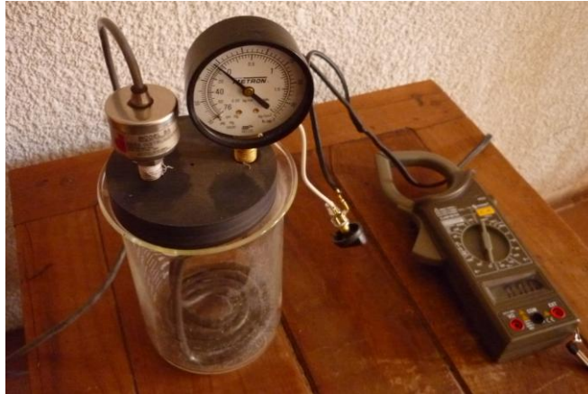
Figura 7. Medición de corriente utilizando un amperímetro de pinza
