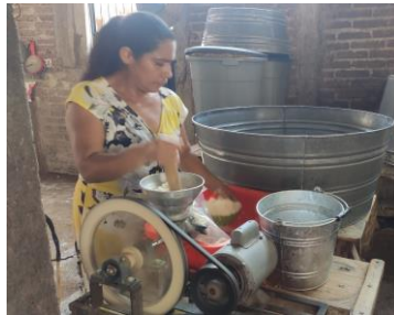
Figura 12. Molido de la cuajada con un molino eléctrico. Fuente: Fuente propia, fotografía tomada en queserías.
