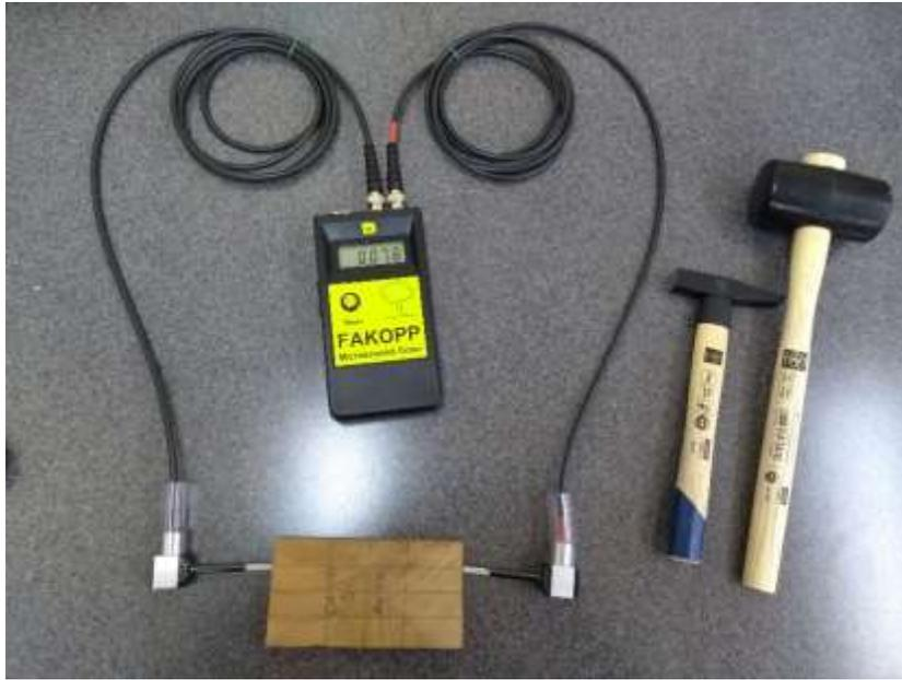
Figura 3: Tiempo de transmisión de la onda con el equipo Fakopp, con el martillo más grande se clavaron los sensores a la madera, con el chico se golpeó el sensor para generar la onda.
