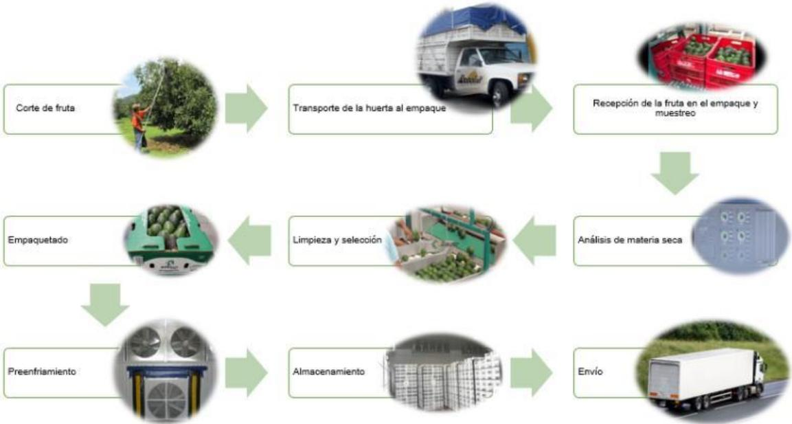
Figura 32. Proceso de Producción de la empacadora.
