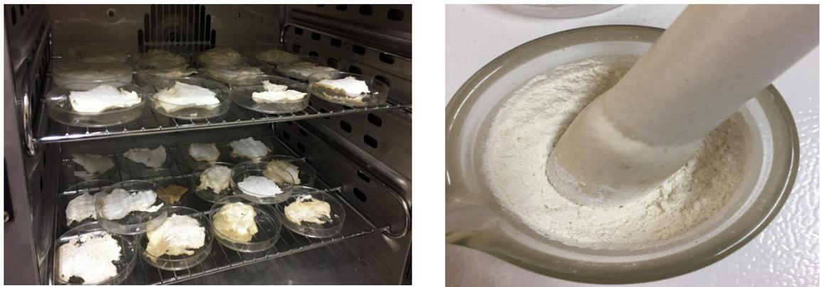
Figura 16. Secado convectivo de mucílago a 50 °C por 24 h, y molienda en un mortero de porcelana hasta la obtención de un "polvo fino".
