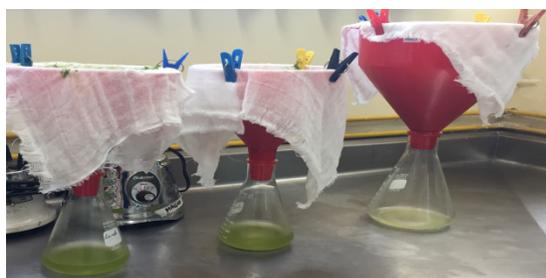
Figura 14. Molienda de pencas de nopal (variedad M. Alta) y filtración del “licuado” obtenido para separar el mucílago (baba) de la fibra.
