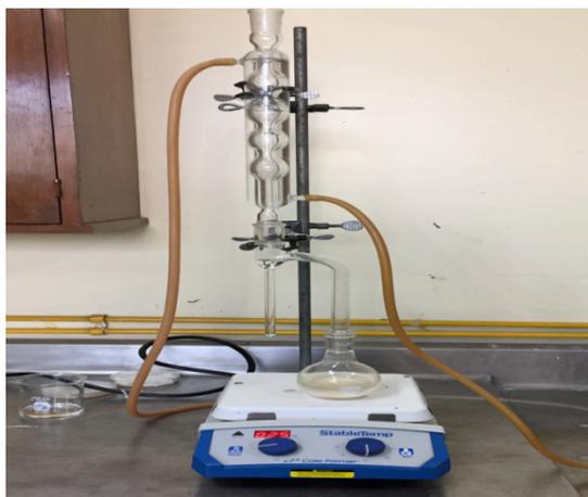
Figura 17. Ensamble de trampa Bitwel y condensador para la medición de humedad de los 5 mucílagos estudiados.
