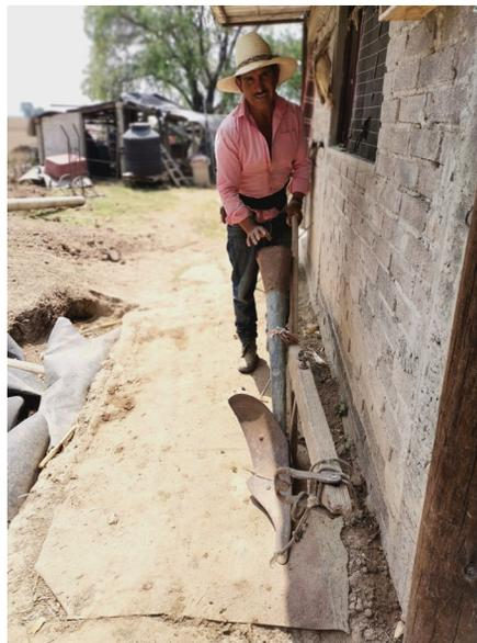
Figura 5. Arado tipo Oliver con aditamentos para siembra.
