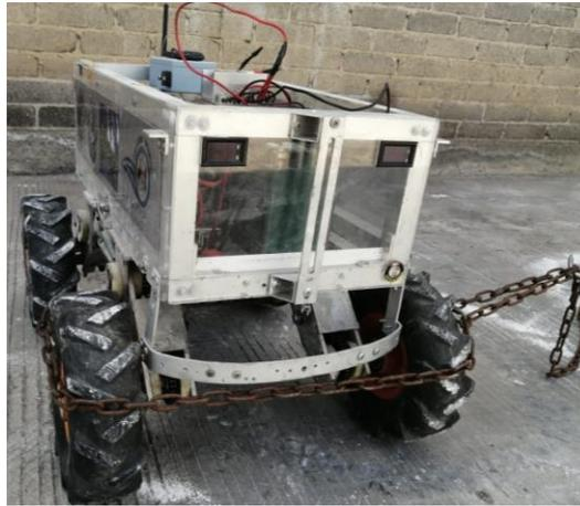
Figura 16. Medición de la fuerza de resistencia lateral (Fuente: autor 2020).
