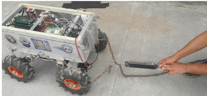
Figura 14. Medición de la fuerza de fricción (Fuente: autor 2020).
