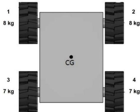
Figura 21. Distribución de las masas de las ruedas del robot (Fuente: autor 2020).
