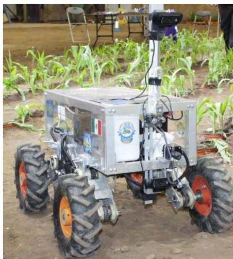
Figura 22. Robot tipo skid steer Voltan con sensores (Fuente: autor 2017).
