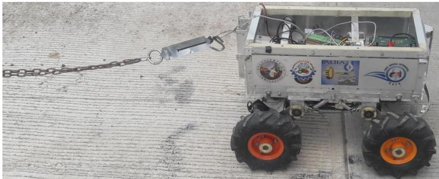
Figura 15. Medición de la fuerza de resistencia a la rodadura (Fuente: autor 2020).
