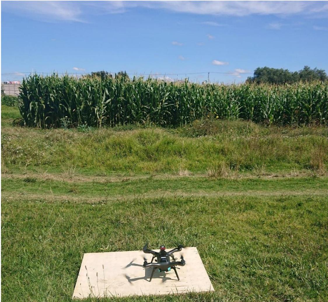
Figura 3-1. VANT “3DR solo” equipado con un sensor multispectral Parrot Sequoia utilizado para obtener imágenes de alta resolución espacial.
