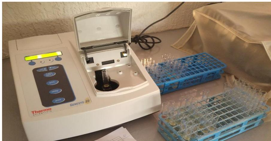
Figura 22. A) Muestra en embudo de separación. B) Centrifugado de muestras. C) Lectura de absorbancia con espectrofotómetro a 520 nm.
