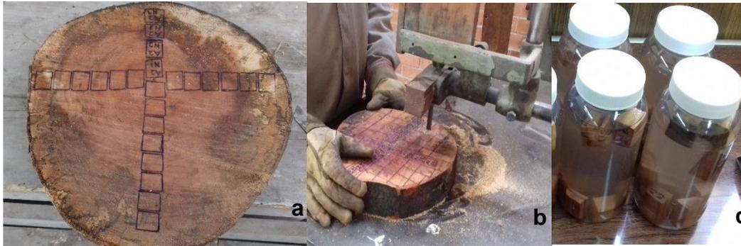
**Figura 4.2.** a. Marcado, b. cortado, c. saturación de probetas.
