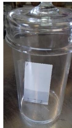
**Figura 5.5** Elución de placa en cámara cromatografica
