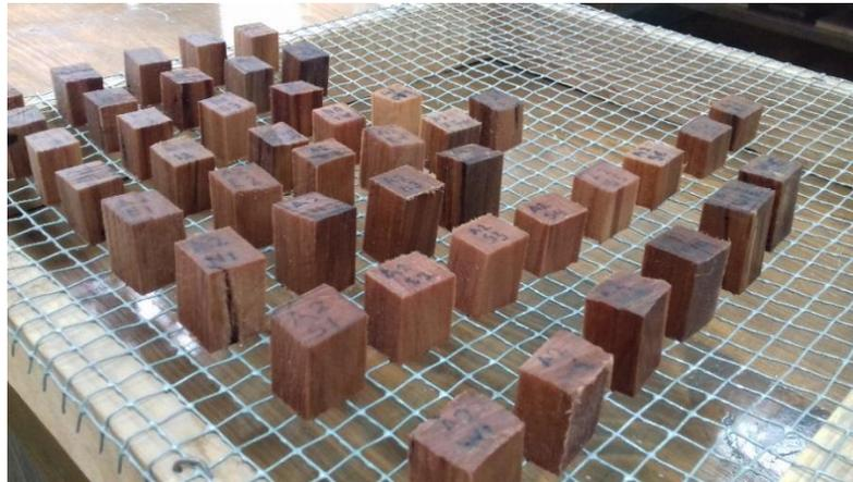
**Figura 4.4** Probetas expuestas al medio ambiente del laboratorio
