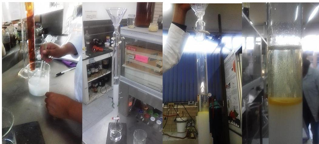
**Figura 5.9** Preparación de columna cromatografica
