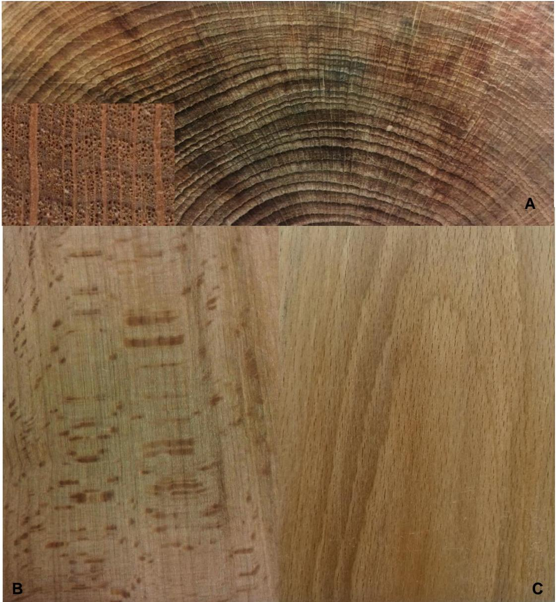
**Figura 3.16** Cortes típicos macroscópicos de la madera de *Fagus grandifolia* subsp. *mexicana*. **A:** Corte transversal, **B:** Corte radial, y **C:** Corte tangencial.
