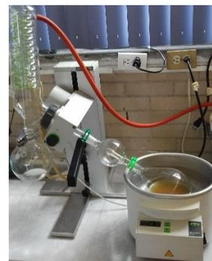
Figura 5.2 Evaporación de disolvente
