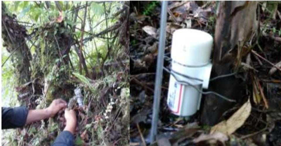
Figura 4. Datalogger colocado en los sitios de monitoreo.
