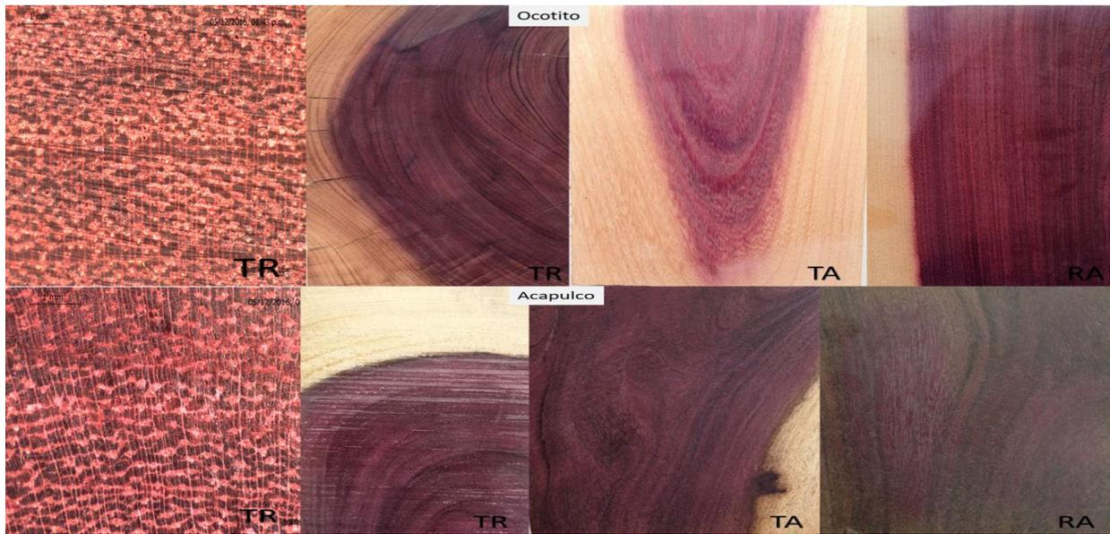
Figura 3. Anatomía macroscópica de *P. mexicana*, cortes típicos (TA=tangencial, TR= transversal y RA= radial) de Ocotito y Acapulco, Gro.
