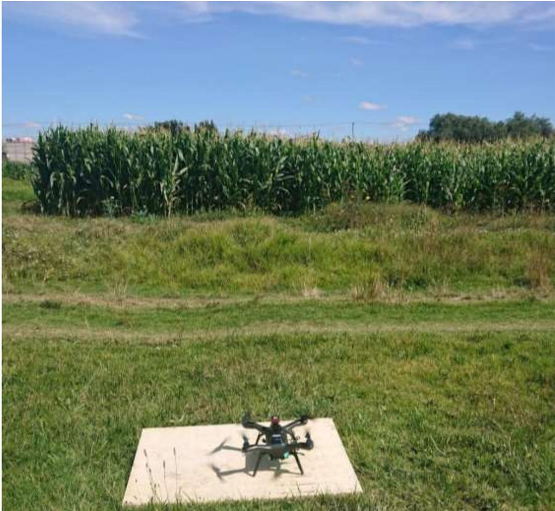
Figura 3-1. VANT “3DR solo” equipado con un sensor multiespectral Parrot Sequoia utilizado para obtener imágenes de alta resolución espacial.
