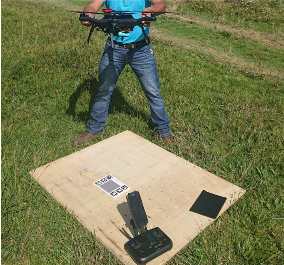
Figura 4-2. Toma de imágenes del “calibration target” con el del sensor Parrot Sequoia antes de realizar los vuelos.
